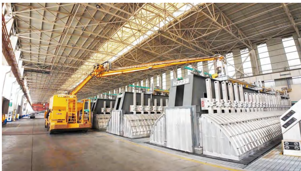
图 15-9 600 千安电解槽列装
